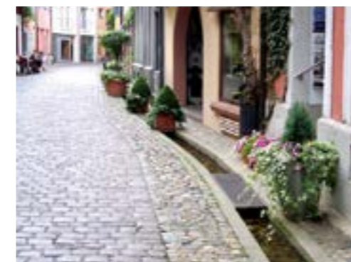
Referentie: afwatering in Freiburg (DE)
